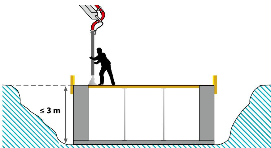
No caso de um teto do rés-de-chão e uma altura de queda de  $\leq 3\text{ m}$  pode prescindir-se de uma proteção contra queda.
